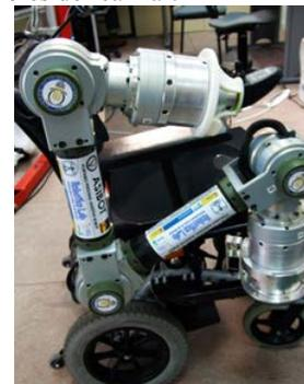
Figura 2: Imagen del robot asistencial ASIBOT.
